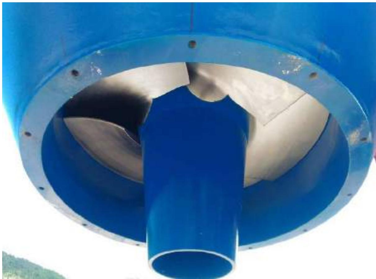
CENTRALE DI PRODUZIONE – VISTA DELLA GIRANTE DI UNA DELLE DUE TURBINE
